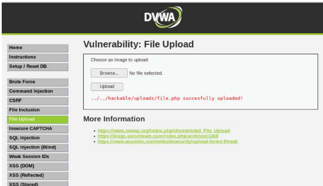
Obr. 4: DVWA: Ukázka příkladu na útok nahrání nežádoucího souboru PHP (file upload)
