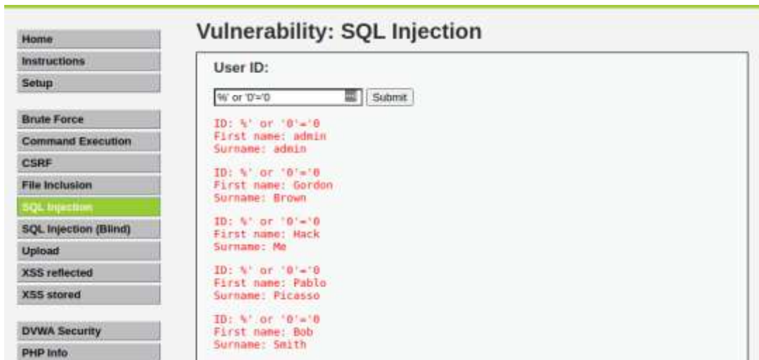
Obr. 3: DVWA: Ukázka příkladu na útok vložení SQL příkazu (SQL injection)
