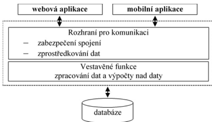
Obrázek 2: Blokové schéma implementovaného systému. Zdroj: vlastní
